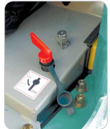
> выключатель массы, входящий в базовую комплектацию
