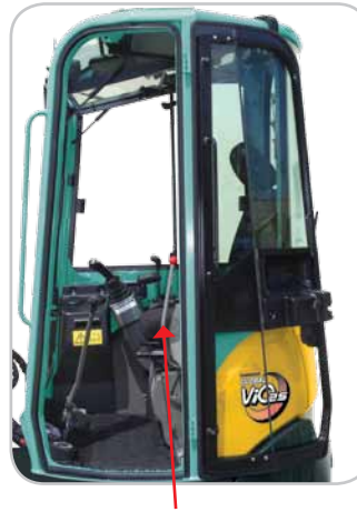
> большой рычаг безопасности
