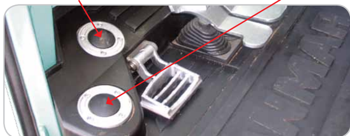
Ножное управление 3-м гидравлическим контуром
