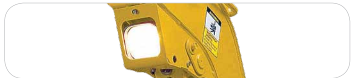
> Вмонтированная в корпус стрелы фара рабочего освещения
