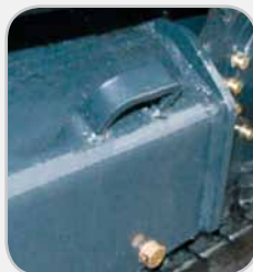
крепёжные проушины на ходовой части и отвале
